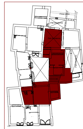
Localització del volums construïts cap a la primera meitat del segle XVII
